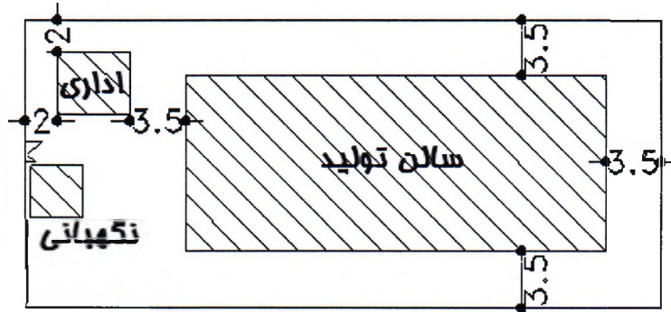
تصویر شماره ۳- وضعیت حریم در اراضی تا ۱۰۰۰ مترمربع با احداث ساختمان اداری در خارج از ساختمان تولید
